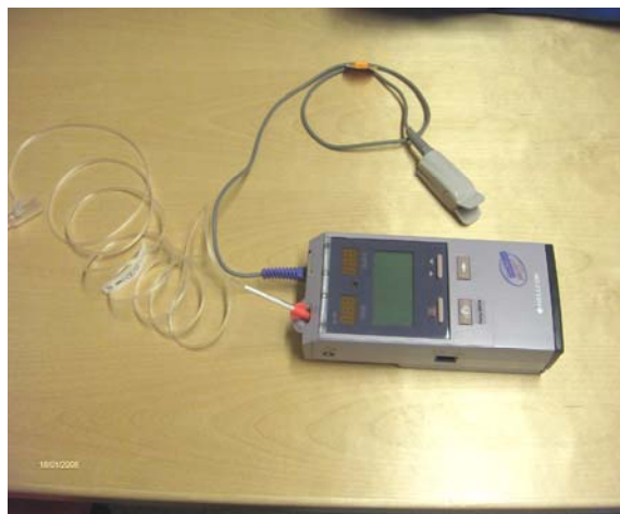
Kapnograf til måling af CO 2 i udåndingsluft og måling af O 2 -indhold i blodet
